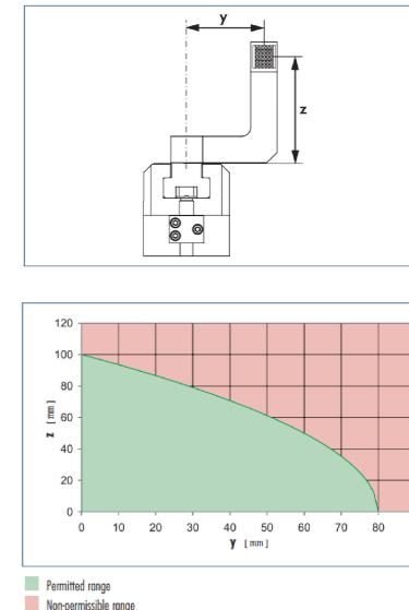
推荐的工作重量 (Recommended workpiece weight) : 2.1kg
