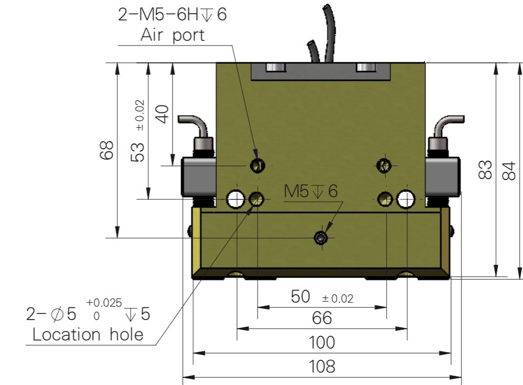
名称：气动平行两爪-带断气保护
